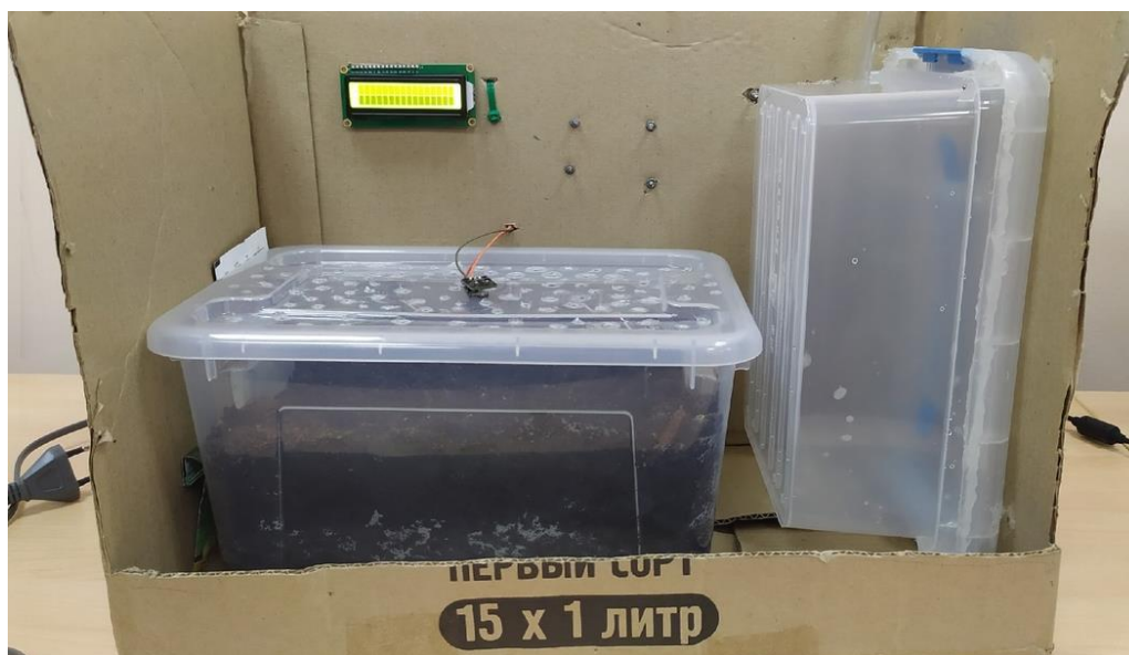
Рисунок 1 – Автоматическая теплица на базе Arduino
