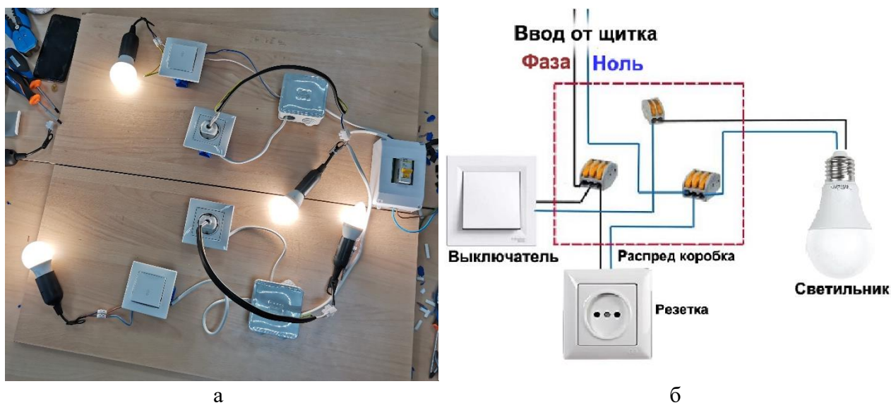
Рисунок 1 – Внешний вид имитации электропроводки (а), схема электропроводки (б)
