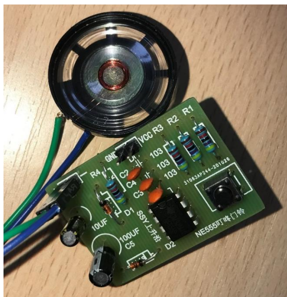
Рисунок 1 – Внешний вид миниатюрного электронного дверного звонка
