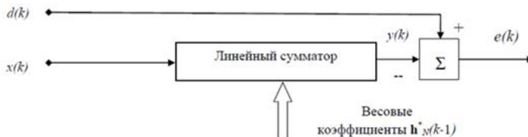
Рис. 2. Вычисление сигнала ошибки в адаптивном фильтре
