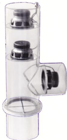
Рис. 4. Защита датчиков пульсаций давления от проникновения паров жидкости с помощью повторителя инфразвука
