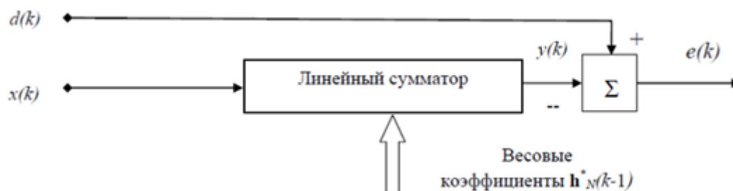
Рис. 2. Формирование сигнала ошибки в адаптивном фильтре
