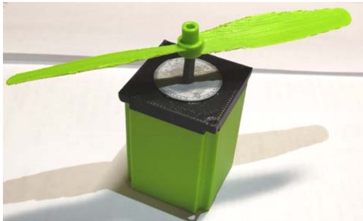
Рис. 3. Образец корпуса шагового двигателя, изготовленный методом 3D печати
