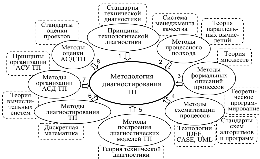
Рис. 1. Методология диагностирования ТП с использованием операторных схем
